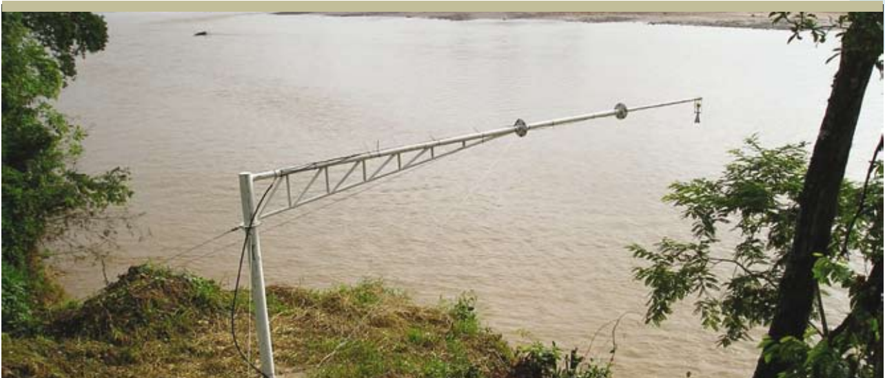
Estación remota San Telmo Brazo y sensor de radar. Río Grande de Tarija, límite entre Argentina y Bolivia
