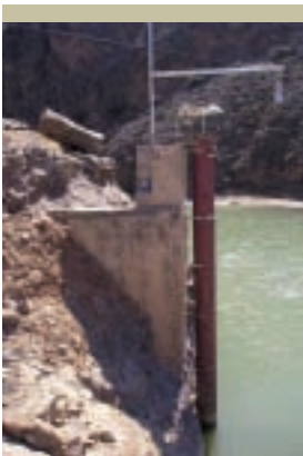
Brazo, sensor de radar y escala en la estación remota La Angostura, Bolivia
