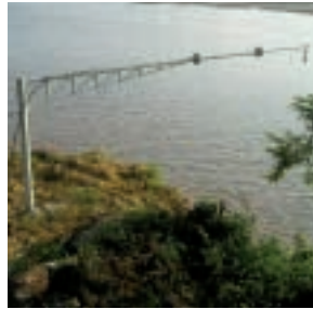
Brazo y sensor de radar estación San Telmo, Bolivia
