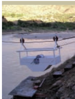
Cable y vagoneta para medición de aforo en la estación remota La Angostura, Bolivia
