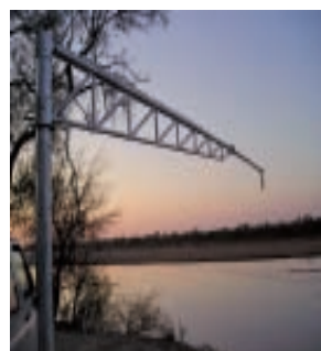
Brazo y sensor de radar estación Sauzalito, Argentina
